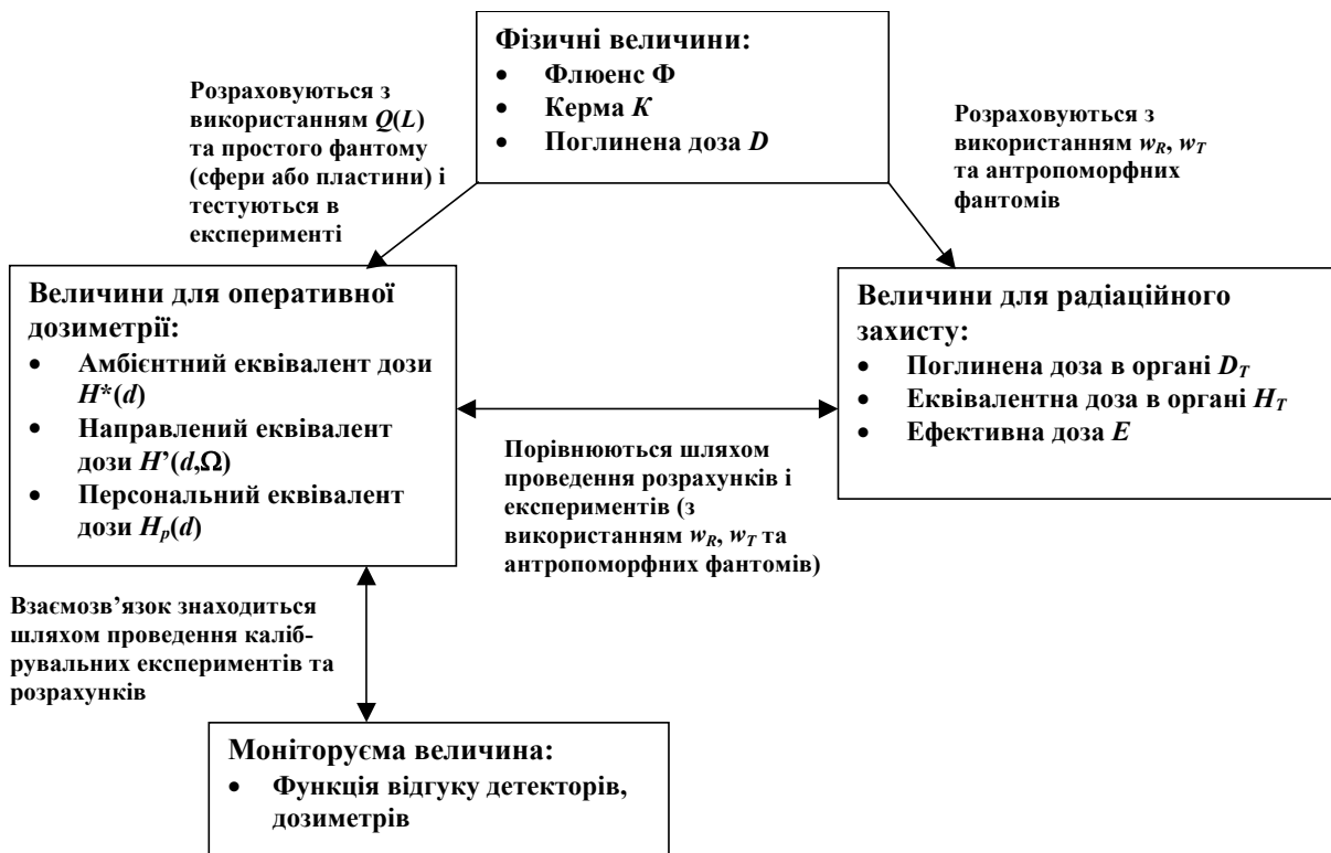
Рис.4. Взаємозв'язок між величинами, що використовуються з метою радіаційного захисту від зовнішнього іонізуючого випромінювання.
