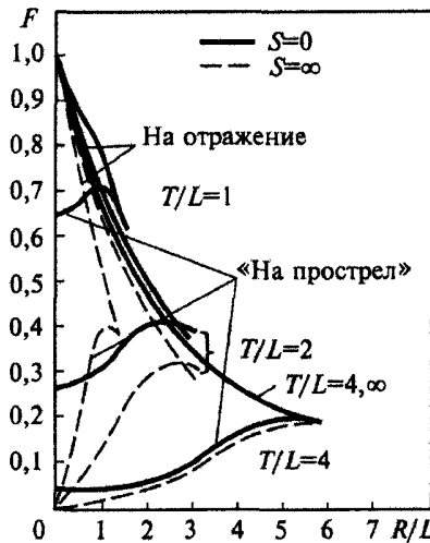
Рис. 8.7.11. Расчетная эффективность собирания вторичных электронов на поверхности в режиме на отражение и «на прострел» в зависимости от глубины проникновения первичных электронов R (от их энергии), толщины вторичного эмиттера T и диффузионной длины L ( S — скорость рекомбинации на тыльной поверхности)
