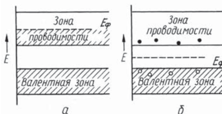
Рис. 128. Схематичне зображення рівнів енергії в метані (а) та в напівпровіднику (б).
