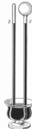
Рис. 13. Дослід Торрічеллі. Над поверхнею ртуті – вакуум.
