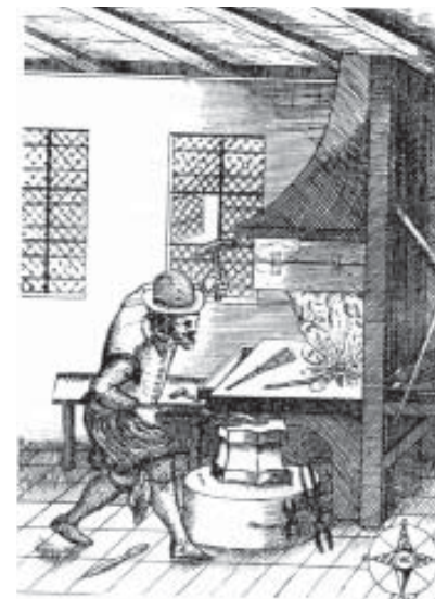
Рис. 55. кування магнітів (рисунок із книги Гілберта).
