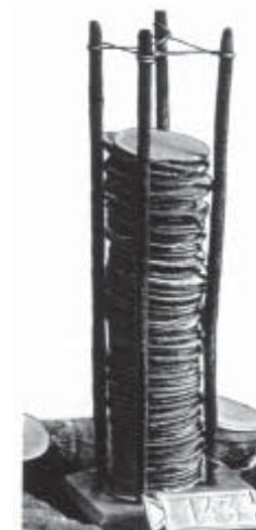
Рис. 67. Перший гальванічний елемент Вольти.
