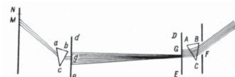
Рис. 26. Схема досліду Ньютона з розкладу білого світла на спектр.
