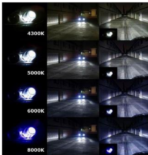
Рис. 6.6. Колірна температура фар автомобіля.
