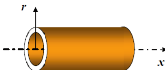
Рис. 3. Трубчатый пьезоэлемент
