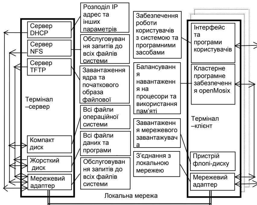
Рис. 1.1 – Схема зв'язків різних компонент апаратного та програмного забезпечення, що використовується для виконання практичного завдання.
