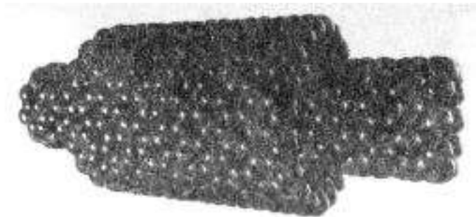
Рис. 5.32. “Наноподшипник” на двух нанотрубках
