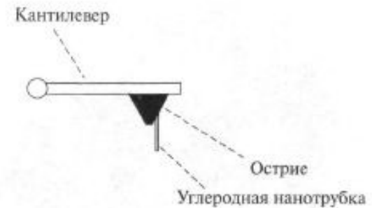
Рис. 5.37. Схема размещения однослойной нанотрубки на кантилере атомного силового микроскопа [8]
