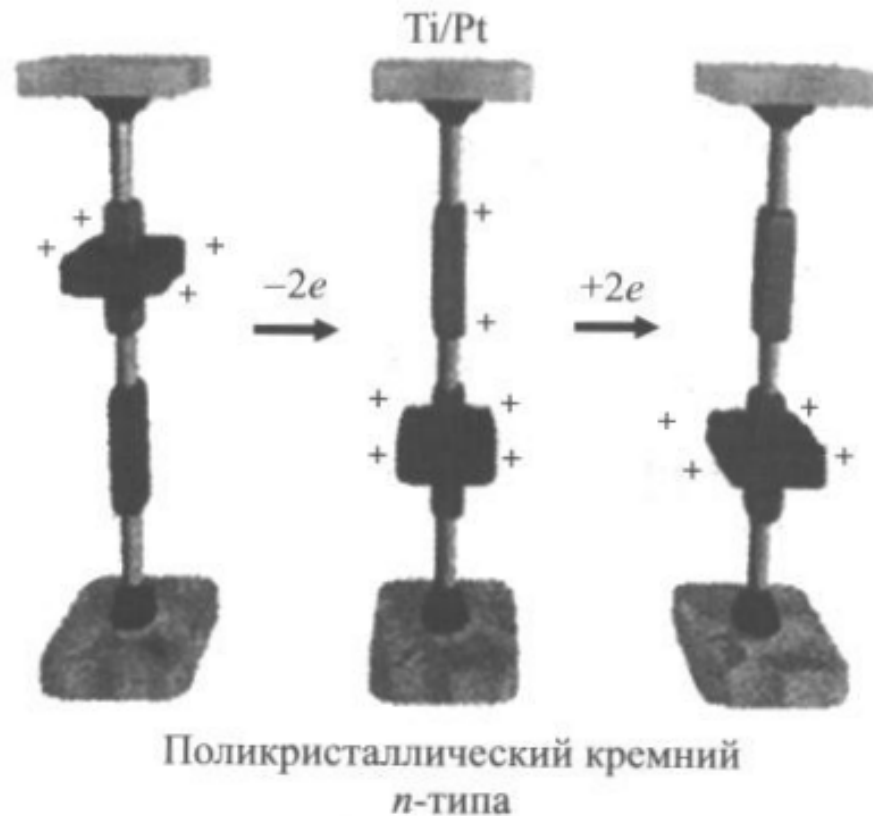
Рис. 3.39. Переключающийся элемент на основе молекулы ротаксана
