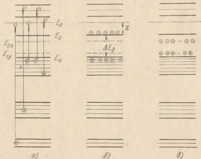
Рис. 2. Установление равновесия в пространстве энергий для неметаллических веществ после прекращения возбуждения. E_0 — уровень вакуума, E_c — дно зоны проводимости, E_v — потолок валентной зоны, \Delta E_g — запрещенная зона, E_{tn} и E_{tr} — уровни энергии, соответствующие центрам захвата или центрам рекомбинации соответственно для электронов и дырок.
