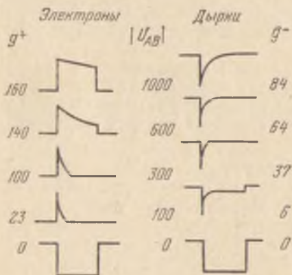
Рис. 9. Осциллограммы электронного g^+ и дырочного g^- токов ЭВП в алмазе при изменении разности потенциалов U_{AB} на кристалле от 0 до 1000 В [1].
