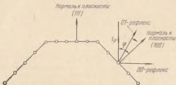
Рис. 18. «Аномальное» движение дифрагированных пучков при дифракции на наклонных плоскостях, возникающих в процессе огранки поверхности кристалла.
