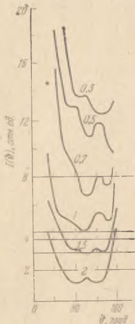
Рис. 8. Угловое распределение упруго отраженных электронов для угла падения \varphi = 75^\circ на поверхность золота [61] при различных энергиях E_p (числа на кривых — в кэВ). Кривые нормированы на единицу при \theta = 162^\circ .
