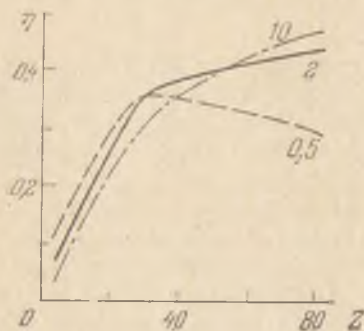
Рис. 34. Зависимость \eta от атомного номера элемента Z для различных значений E_p (цифры на кривых — в кэВ).
