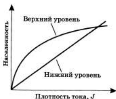
Рис. 10.3 Схематические зависимости населенностей верхнего и нижнего уровней He-Ne лазера от плотности электрического тока
