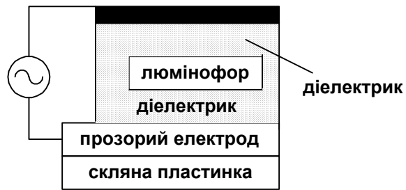
Рис.13.5. Схема комірок електролюмінесцентної панелі.
