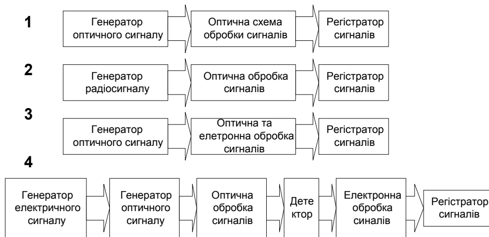
Рис.5.2. Узагальнені схеми оптоелектронних приладів: 1 - фотонних, 2 - радіооптичних, 3 і 4 - оптоелектронних.
