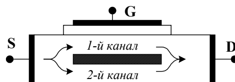
Рис.3.32. Принципова схема квантово-інтерференційного транзистора.
