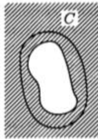
Рис. 8.1. В сплошном сверхпроводнике (заштриховано) имеется цилиндрическая полость. Контур C проходит всюду внутри сверхпроводника на больших по сравнению с \lambda расстояниях от границы полости.
