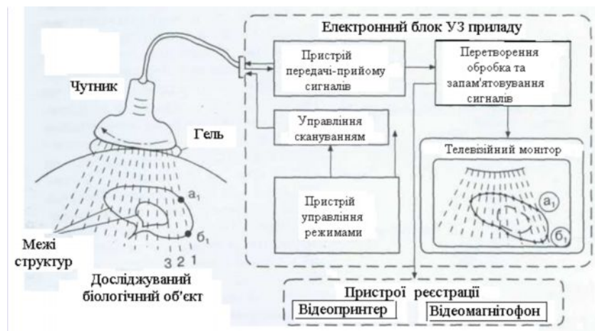
Рис. 3.3 Структурна схема отримання двомірного зображення в УЗ приладі
