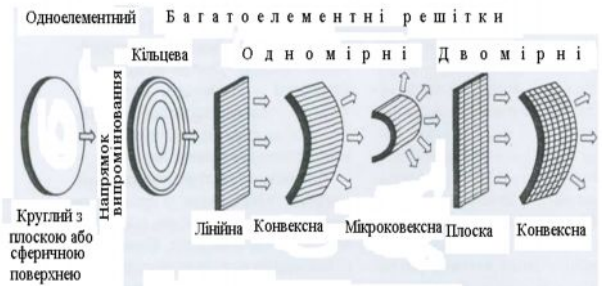
Рис. 3.5 Конфігурація п'єзоелементів в різноманітних типах датчиків.
