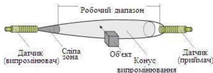
Рис. 4.2. Схема опозитного режиму роботи УЗ датчика
