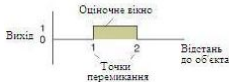
Рис. 4.4. Схема контролю оціночного вікна
