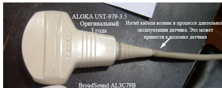
Рис. 4.8. Згин кабеля датчика в процесі роботи
