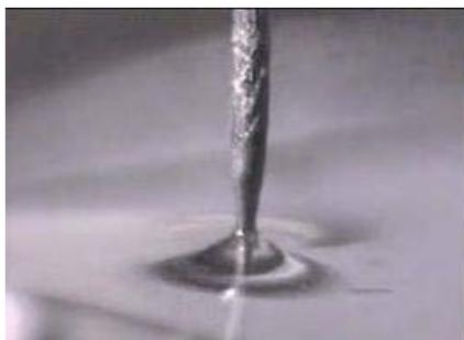
**Рис. 16.** Образование мениска при касании кончика иглы поверхности жидкости
