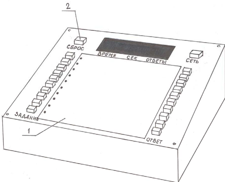
Рисунок 2.3 – Прибор для исследования концентрации внимания
