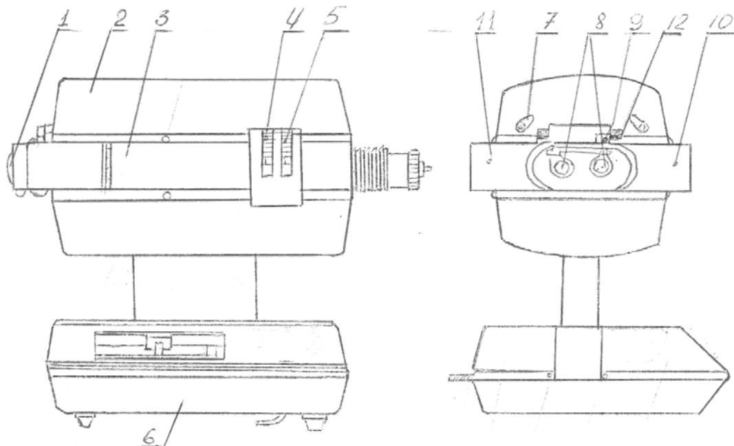
1 – полумаска; 2 – кожух оптического блока; 3 – оптический блок; 4 – диск с тестами; 5 – диск со светофильтрами; 6 – блок питания; 7 – рукоятки шторок для выключения глаз из акта зрения; 8 – коллиматорные линзы; 9 – шкала межзрачкового расстояния; 10 – крышка импульсной лампы; 11 – кожух лампы освещения камеры; 12 – ручки для установки межзрачкового расстояния
