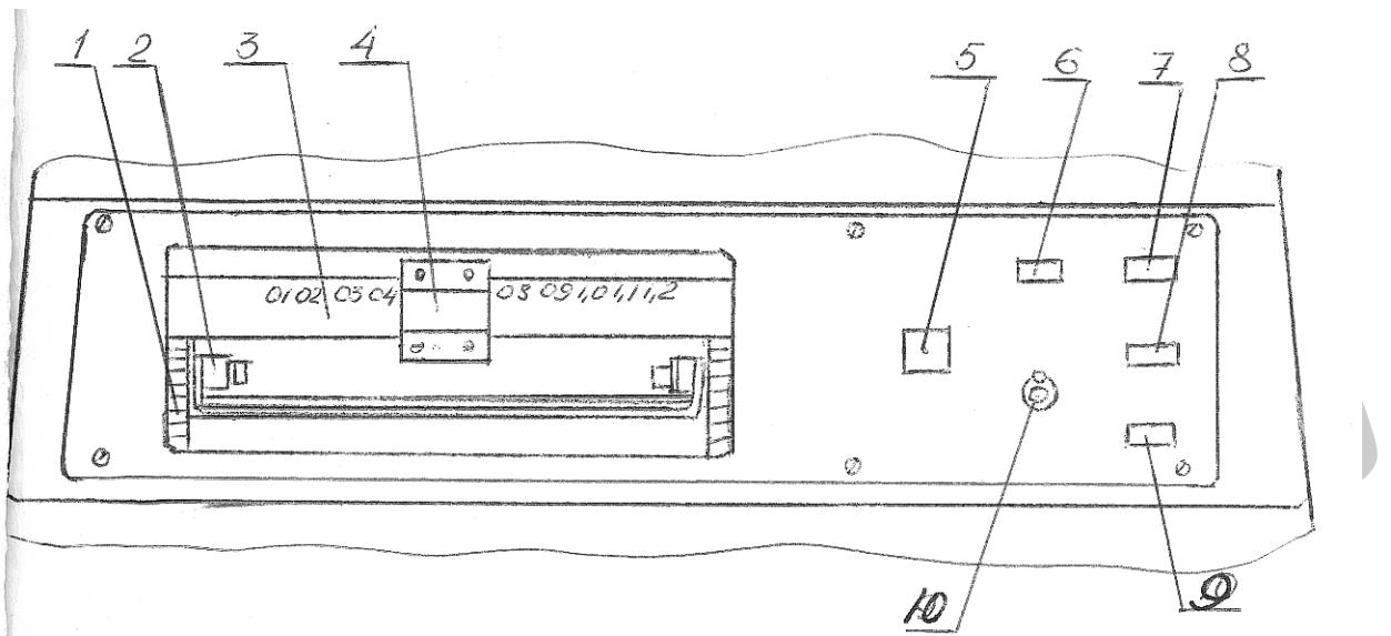
1 – барабан регистрирующего устройства; 2 – прижим; 3 – шкала; 4 – движок;
