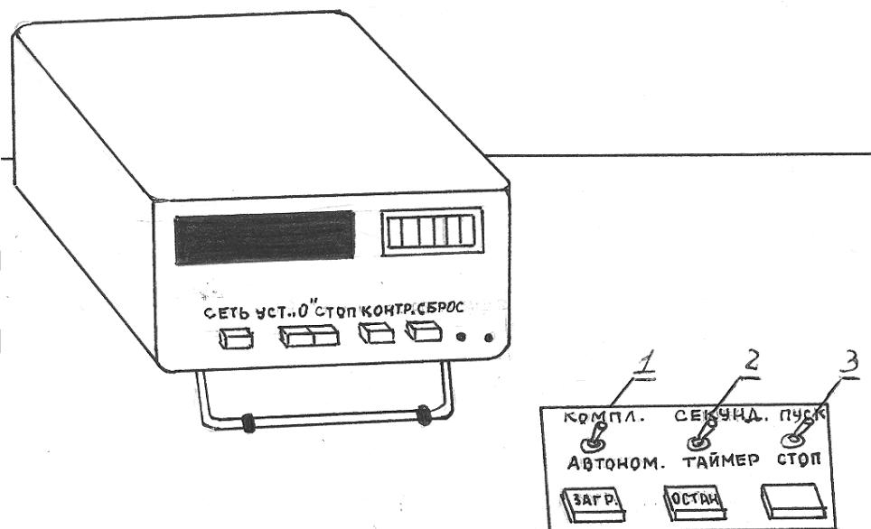
**Рисунок 12.2 – Пульт управления установкой для исследования средств визуальной информации**
