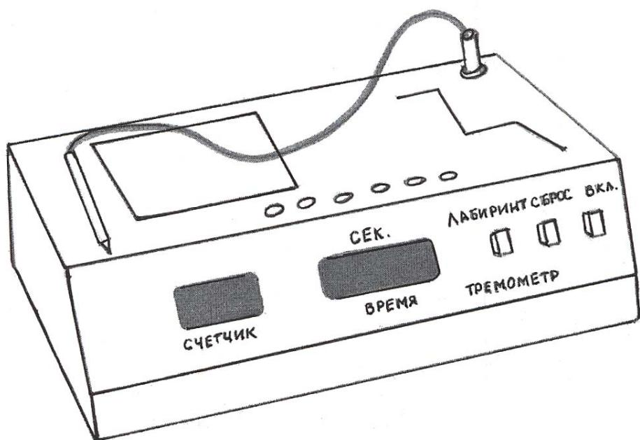
Рисунок 1.4 – Координациотремометр
