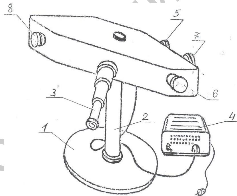
1 – основание; 2 – стойка; 3 – окуляр; 4 – блок питания; 5 и 6 – установочные барабаны; 7 – измерительный барабан; 8 – барабан контрастности
