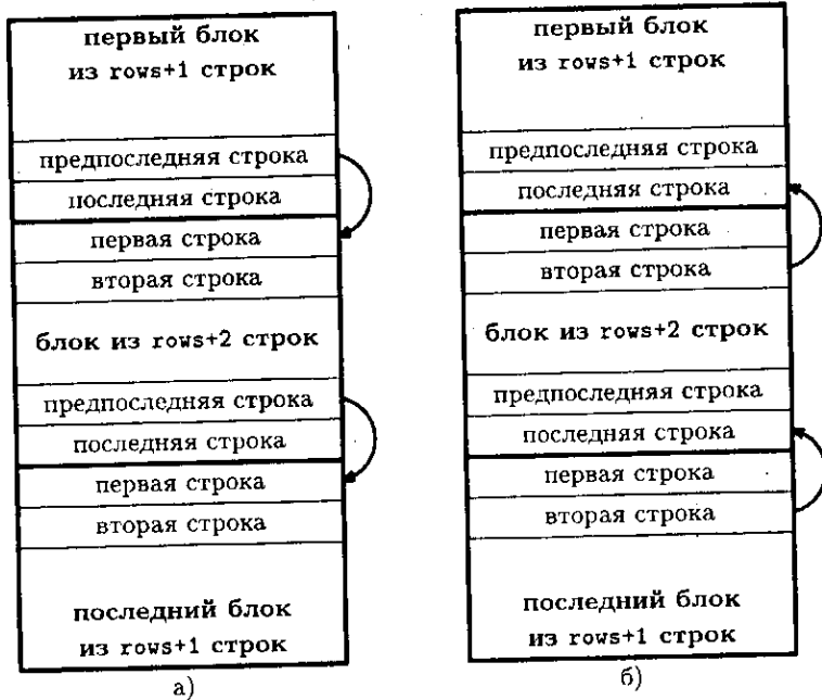
Рис. 11.2. Схема пересылки данных между процессами при вычислении оператора Лапласа
