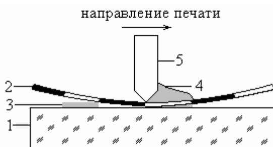
Рис. 4.10. Схема установки для нанесения паст на подложку
