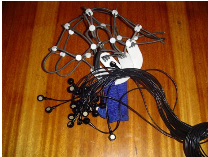
Рис.1. Чашкові електроди та гумовий шолом для їх закріплення.
