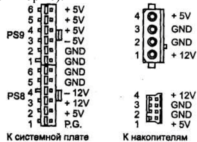
Рис. 13.7. Выходные разъемы традиционного блока питания
