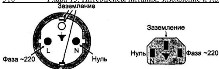
Рис. 13.6. Положение «нуля», «фазы» и «земли»: а — на питающей розетке, б — на выходном гнезде шнура питания
