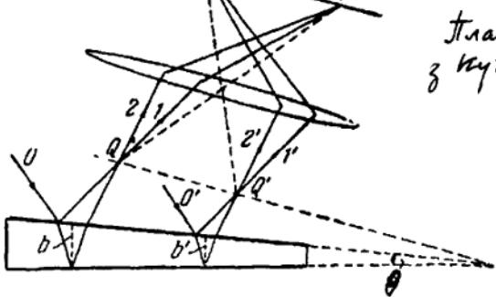
Пластинка у вигляді клина з кутом при вершині  $\theta$
