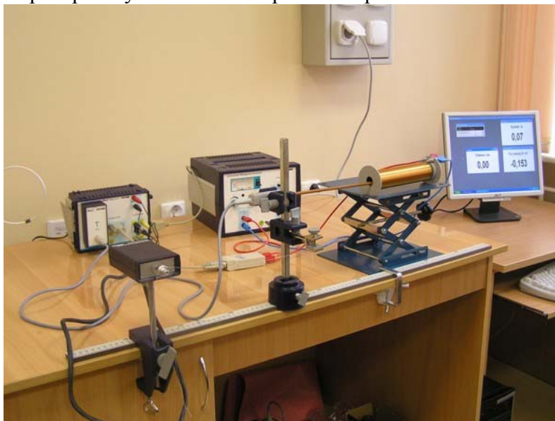
Рис. 7: Общий вид лабораторной установки для измерения магнитного поля
