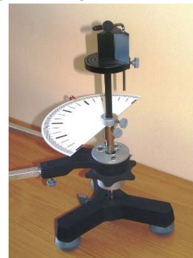
Рис. 7. Установка радиального зажимного приспособления с призмой
