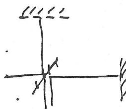
Унтерферометрічний дослід Майклсона
