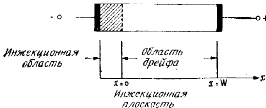
Рис. 7. Идеализированный диод, в котором носители инжектируются при x = 0 и движутся в области дрейфа со скоростью насыщения.
