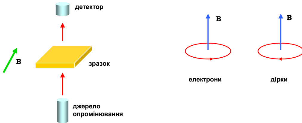
Рис. 15.31. Схема експерименту з вимірювання резонансного поглинання електромагнітного поля напівпровідником під дією сталого магнітного поля.
