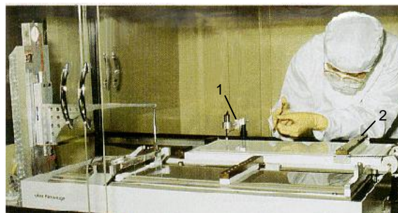
Рис. К3. Ленгмюрівська ванна для отримання ЛБ-плівок. Схема (ліворуч). Праворуч – ЛБ ванна у „чистій” кімнаті. 1 – система витягання зразка з плівкою; 2 – рухомий бар'єр, що дозволяє утримувати заданий поверхневий натяг речовини на поверхні води. Оператор шприцом наносить робочу речовину на поверхню води.
