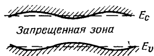
Рис. 5-7. Изменение энергии дна зоны проводимости и потолка валентной зоны атомного полупроводника под воздействием продольных акустических колебаний решетки.
